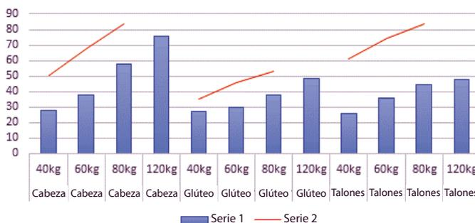
Serie 1: Valor P<sub>máx</sub> medido Serie 2: Umbral P<sub>máx</sub> tolerado
