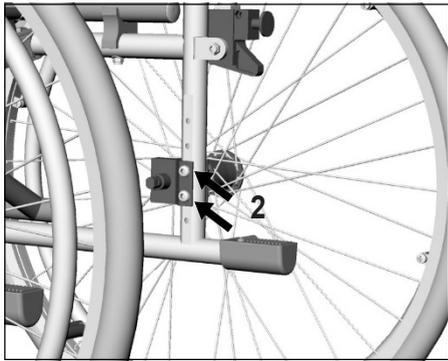
La altura de la rueda trasera se ajusta según su necesidad. Para hacerlo, afloje los tornillos de fijación del adaptador de la rueda trasera (2) y ajústelo a la altura deseada y coloque los tornillos de nuevo.
