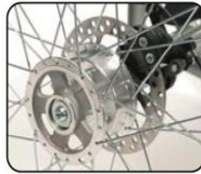
B1 - Freno de disco ruedas traseras
