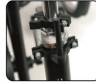
D1 - Sistema de bloqueo para manillar
