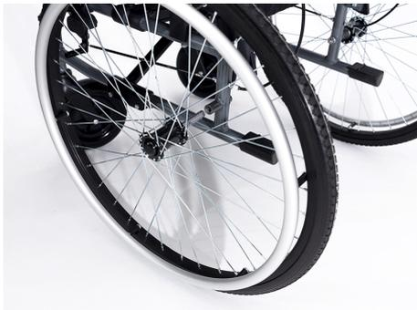
**Ruedas traseras con extracción rápida**
