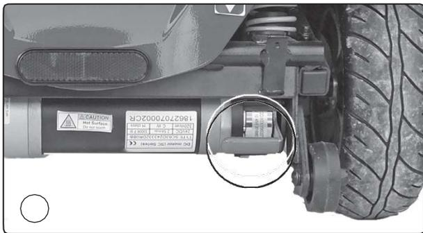
Cuando el vehículo está apagado, los frenos se activan automáticamente. Se llama "Freno anti fallos". Los frenos también se aplican si las baterías están descargadas. Puede haber ocasiones en las que desee mover el vehículo sin encenderlo. Para ello, se ha colocado un dispositivo de rueda libre.
