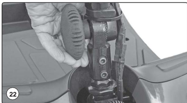
**1. Afloje la perilla del manillar** y levante el manillar hasta la posición deseada; ahora vuelva a ajustar la perilla para fijar el manillar en el lugar. (Fig. 22)
