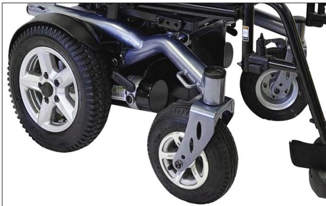
**RUEDAS DELANTERAS DE 230 MM X 60 MM DE ANCHO.**
