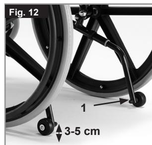
Empurrando o botão de desbloqueio (1), as rodas de segurança podem ser ajustadas para cima ou removidas. Deve existir sempre uma distância entre 3 cm e 5 cm entre a barra e o chão.
