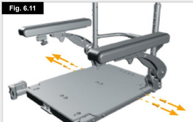
2. Deslice el conjunto de respaldo y reposabrazos hasta alcanzar la posición de profundidad de asiento deseada. Guía de posiciones de profundidad del asiento (A) (Fig. 6.12).
