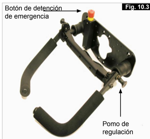
El mecanismo de empuñadura forus está centrado y consta de muelles que siempre volverán el mecanismo hacia la posición central cuando el asistente aleja las manos de la empuñadura. Puede ajustar la altura de las empuñaduras liberando la clavija accionada por muelle ubicada en el costado, ajustando la altura deseada y volviendo a colocar la clavija. (Fig. 10.3)
