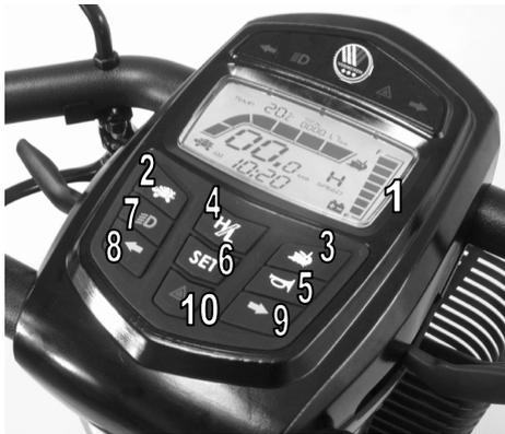
1. Indicador del nivel de batería / pantalla LCD
