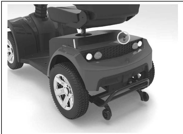
Para proteger el motor de sobrecargas, el scooter dispone de un mecanismo térmico de seguridad en su parte posterior. El fusible térmico parará el motor automáticamente para evitar el recalentamiento, el deterioro rápido o las averías. Puede acceder al dispositivo térmico de seguridad a través de un orificio situado en la parte posterior de la cubierta sintética.
