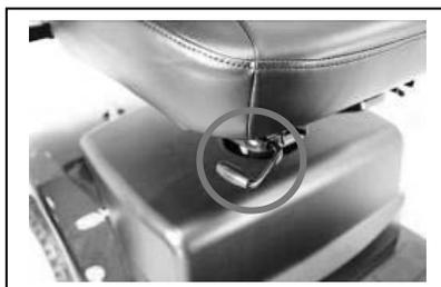
1. Levante la palanca de ajuste de la profundidad del asiento hacia arriba.
