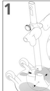
Coloque la placa de apoyo sobre una superficie plana. Inserte el poste con las almohadillas para las rodillas mirando hacia el lado contrario a las ruedas.
