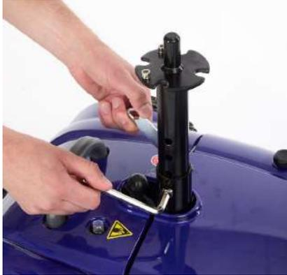
8. Levante y mantenga accionada la palanca situada bajo el asiento y coloque el asiento sobre el tubo del asiento.
