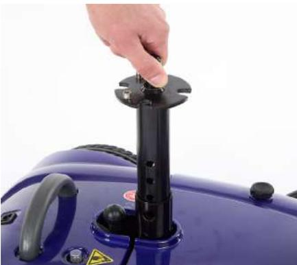
7. Ajuste el tubo del asiento a una altura adecuada utilizando el tornillo y el kit de fijación incluidos.
