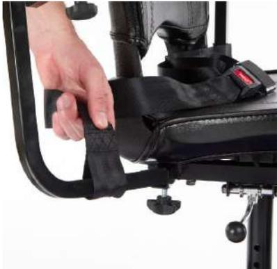
10. Inserte el soporte del joystick en la fijación situada debajo del reposabrazos y asegúrelo utilizando la perilla en estrella incluida.
