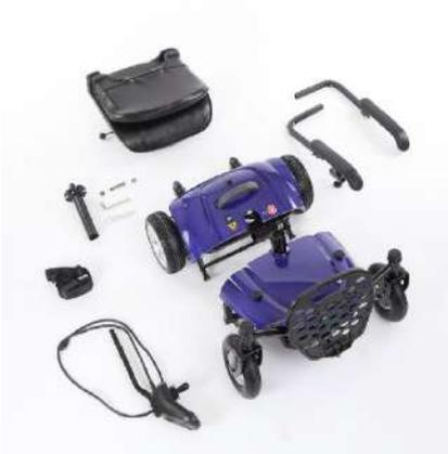
2. Levante el pasador de resorte de la sección trasera y coloque la mitad de la sección delantera sobre los ganchos de la sección trasera.
