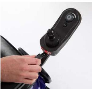
13. Conecte el cable del joystick a la sección trasera de la silla de ruedas eléctrica.
