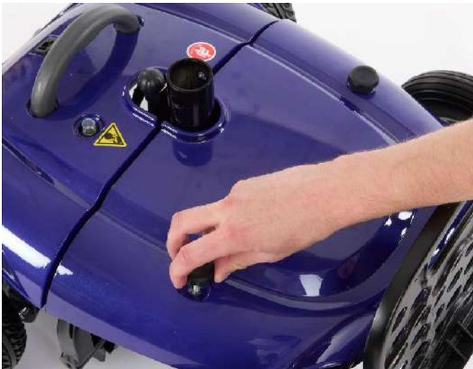
1. Retire los tornillos de mariposa de la tapa de la batería.
