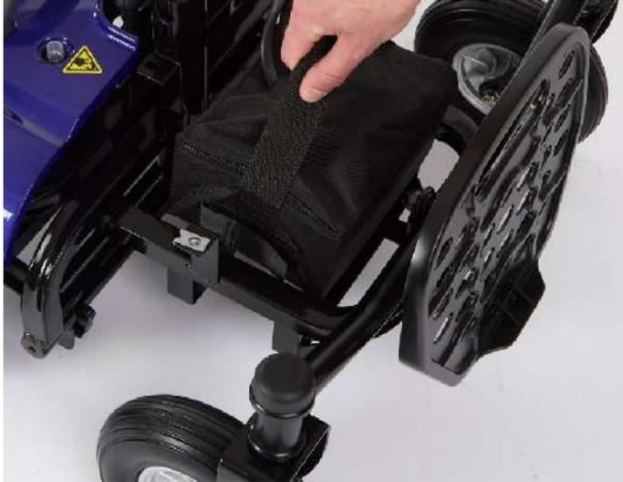
1. Coloque la batería en la bandeja correspondiente.
