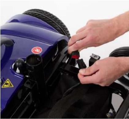
5. Vuelva a colocar la tapa de la batería y asegúrela utilizando los tornillos de mariposa.
