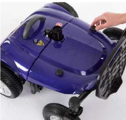
4. Conecte el cable de la batería al cable de alimentación.
