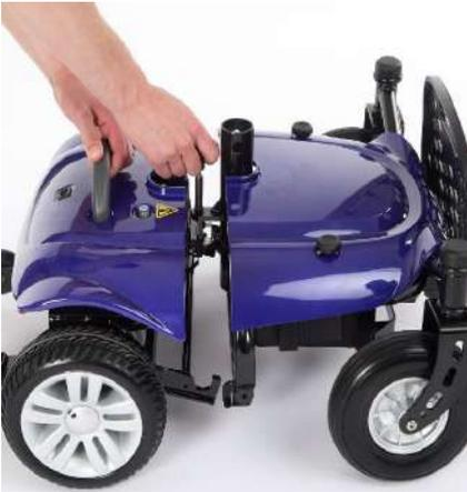
3. Retire los tornillos de mariposa de la tapa de la batería y levante la tapa para separarla de la base de la silla de ruedas eléctrica.
