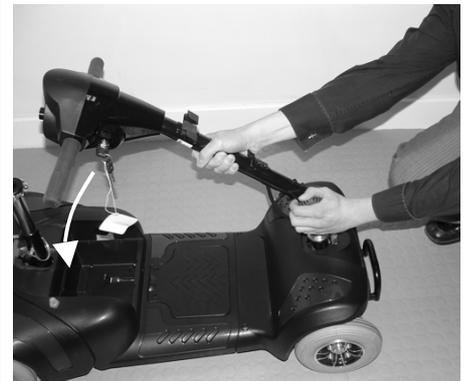
3. Afloje el tornillo de ajuste del manillar, dóblelo hacia abajo y vuelva a apretar el tornillo.
