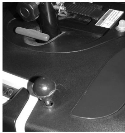
Tire de la palanca hacia arriba y el scooter podrá ser movido manualmente. (Vea foto izquierda)
