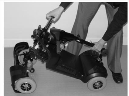
6. Levante la parte delantera hasta que las clavijas inferiores liberen los soportes de fijación curvados de la parte trasera.
