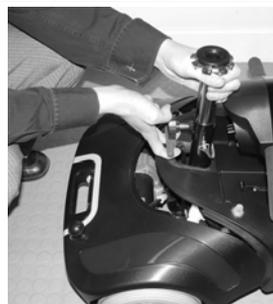
5. Levante el scooter usando el soporte del asiento, mientras tira de la palanca roja detrás del soporte del asiento.
