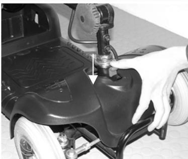
4. Bloquee las ruedas delanteras y el manillar tirando hacia abajo del retén de bloqueo.
