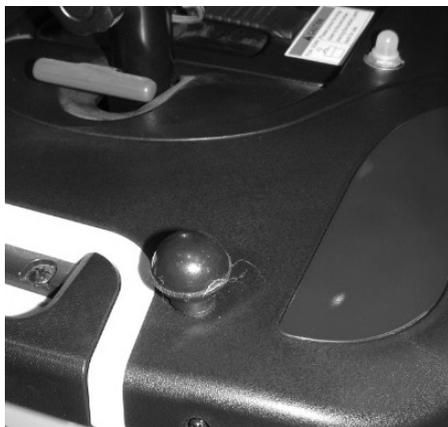
Presione la palanca hacia abajo completamente y el scooter será impulsado por el motor. (Vea foto izquierda)
