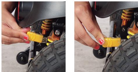
**Nunca deje el scooter desatendido mientras esté en el modo de rueda libre, ya que rodará por una pendiente. El modo 'rueda libre' solo debe usarse en una emergencia para mover el scooter debido a un corte de energía. NUNCA mueva el scooter en este modo mientras esté ocupado. NUNCA remolque el scooter.**
