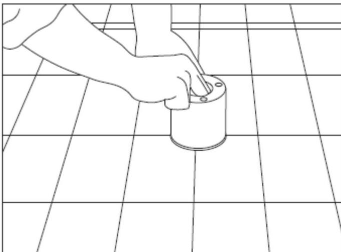
5. Insertar una barra de prueba en el zócalo para comprobar que el agujero se ha taladrado correctamente.
