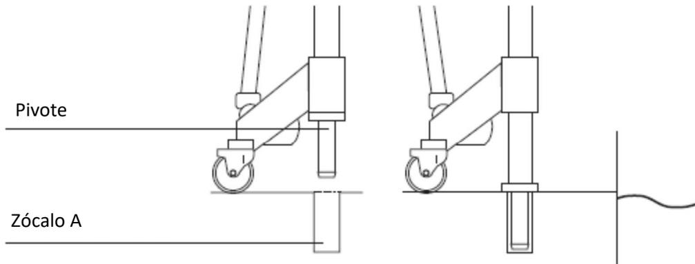
Para hacerlo, pulse el botón "ON" (activar) del control manual hasta que el pivote esté colocado totalmente dentro del zócalo.
