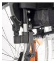
Respaldo ajustable en ángulo de -12° a 12°
