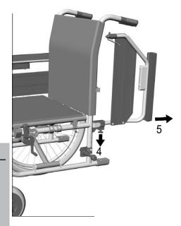
Para la conversión del freno de estacionamiento, primero desmonte los frenos de estacionamiento.
