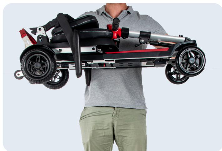
El scooter Formentera ha sido diseñado especialmente para ser superligero. Su peso es de **21 kg sin batería**, y de **22,70 kg con la batería** de litio de 10 Ah. Gracias a su ligereza, es perfecto para levantarlo y manipularlo con facilidad. Es muy ligero pero a la vez extremadamente resistente. Fabricado en aluminio de alta calidad, puede soportar hasta un máximo de **125 kg**.
