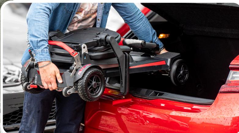
Junto a su peso superligero y medidas supercompactas, el scooter Formentera es plegable. El asiento y el mástil se pueden plegar manualmente de manera muy fácil y rápida, quedando en unas medidas muy reducidas, similares a las de una maleta: **46 x 97 x 34 cm** (ancho x profundidad x alto). Además, cuenta con ruedas de transporte incorporadas para poder arrastrarlo como una maleta.
