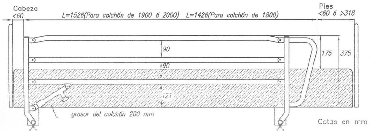
Estructura de acero con tres barras de tubo  $\varnothing 25 \times 1.5$ mm. y asa de acero.
