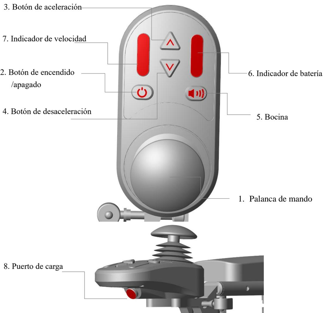
1. Palanca de mando: permite controlar la dirección y la velocidad de la silla de ruedas. Empuje la palanca de mando en la dirección deseada.
