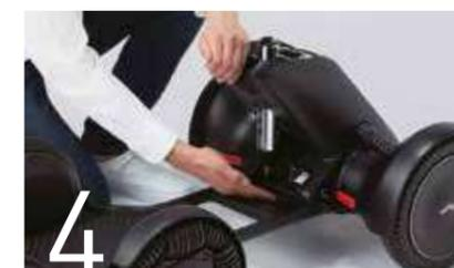
4 Tira de la palanca del lateral de la batería para separar las dos partes del chasis.
