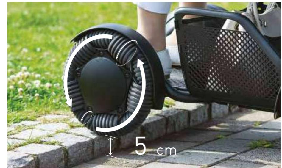
Con sus dos potentes motores y sus grandes ruedas omnidireccionales delanteras, puedes superar sin esfuerzo obstáculos de hasta 5 cm de altura.
