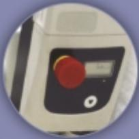
La caja de control dispone de una pantalla LCD en la que indica los ciclos de uso y el nivel de carga de las baterías. También incorpora un sistema de protección de sobrecarga, para no superar el peso máximo a modo de seguridad.
