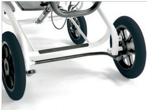
Frenos de tambor que se accionan con un solo mando a los pies
