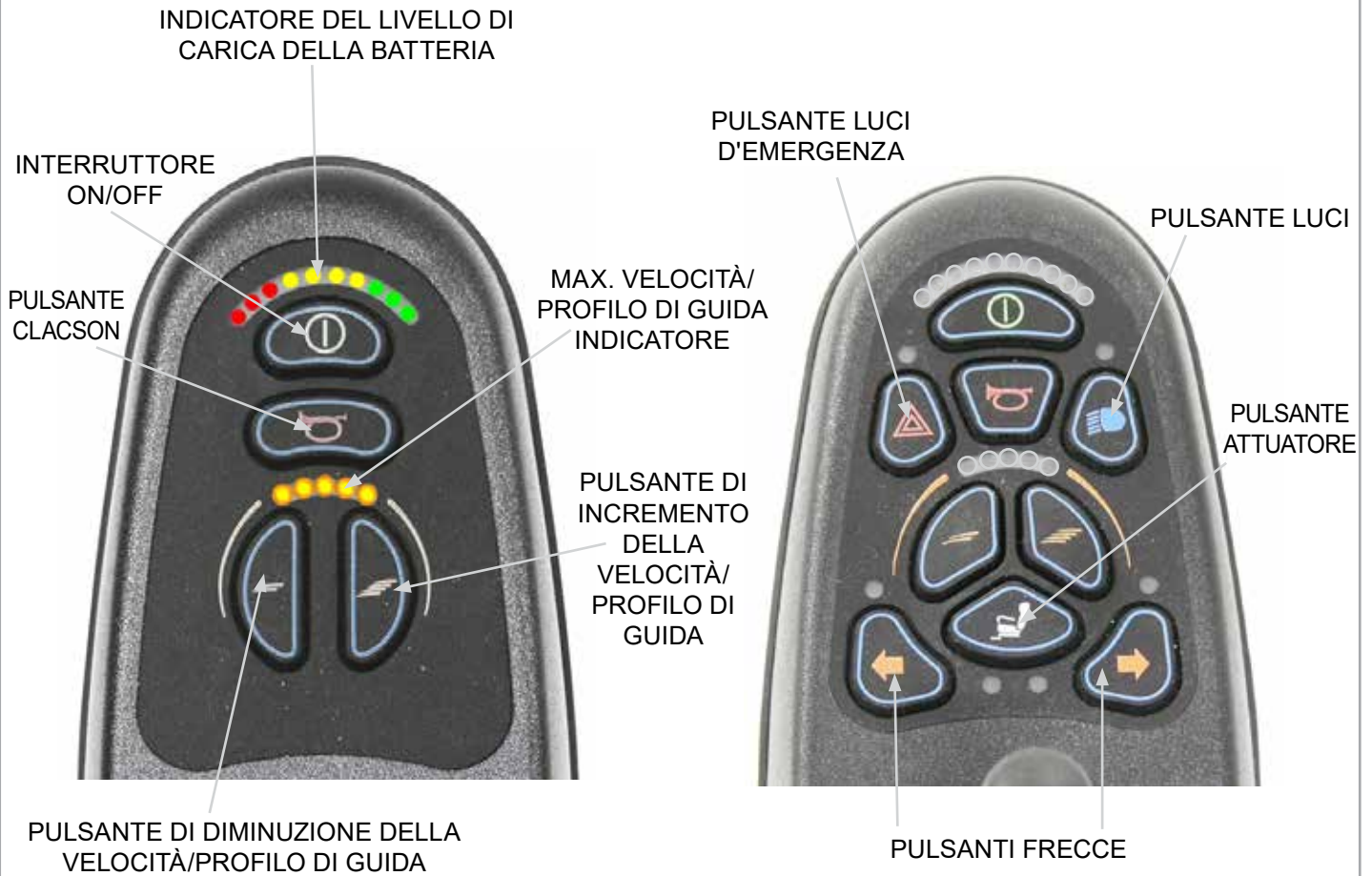
DISPOSIZIONE DEL PANNELLO DI COMANDO VR2
