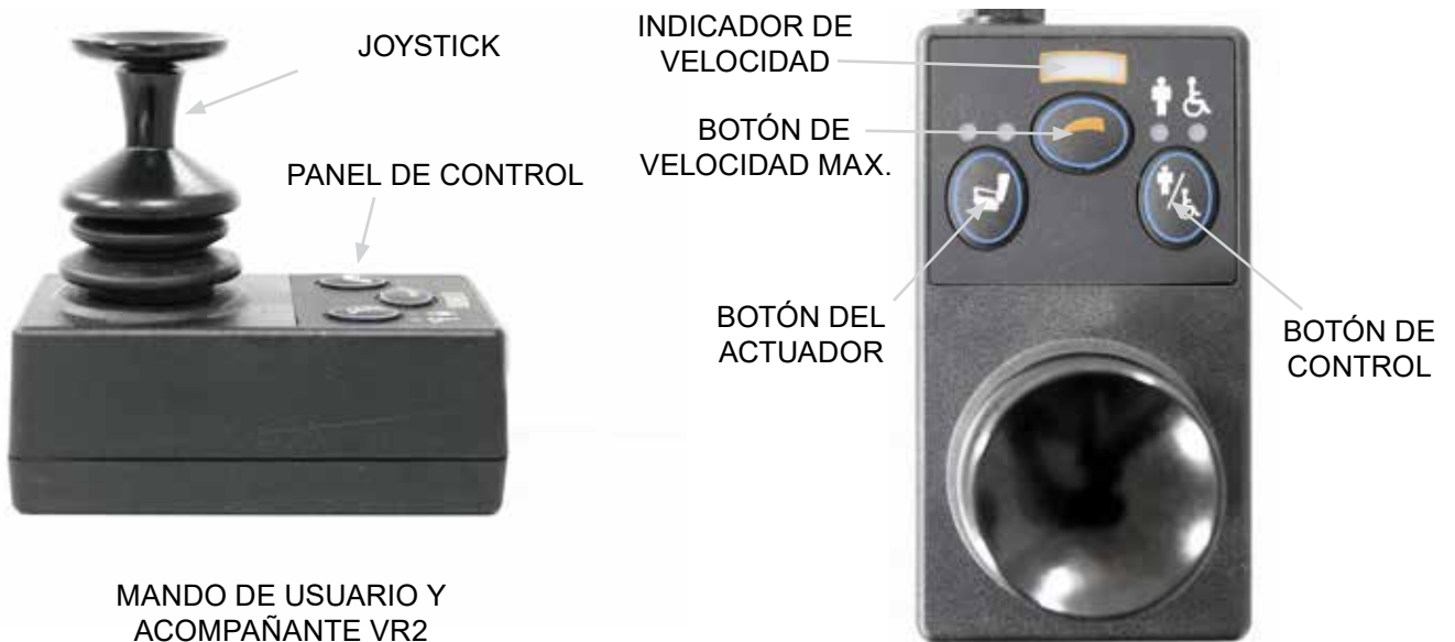
DISTRIBUCIÓN DEL PANEL DE CONTROL DE VR2
