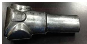
Pieza del respaldo a 90° fijo, tras el proceso de forja
