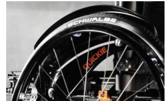
Protector lateral de aluminio con fender en el color del armazón
