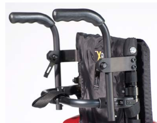
Empuñaduras ajustables en altura
