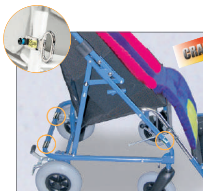
Accesorio Ref.: 891 Cuatro anillos de anclaje. Para el transporte en vehículos, en dirección al sentido de la marcha. Coches, autobuses, etc.
