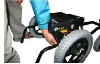
3. Revise que la caja de baterías y la estructura quedan apretados
