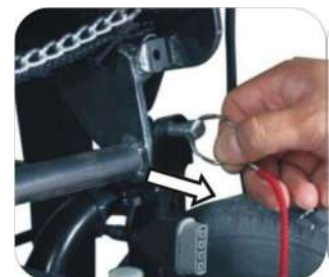
6. Saque los pasadores a ambos lados de las bases de montaje.
