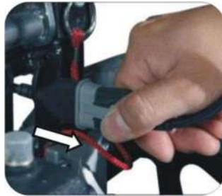
5. Desconecte el cable del conector de transmisión
