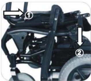
4. Pliegue el respaldo hacia delante y presiónelo.
