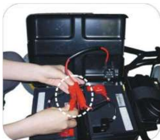
10. Desconecte la batería.
