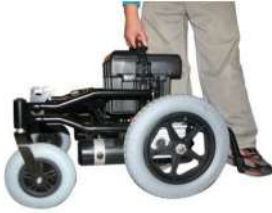
1. Ponga la caja de baterías agarrada con una sola mano y de forma vertical.
