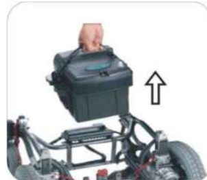
8. Sostenga la batería por la correa y levántela.
