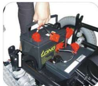
11. Levante la batería por sus agarraderas.
